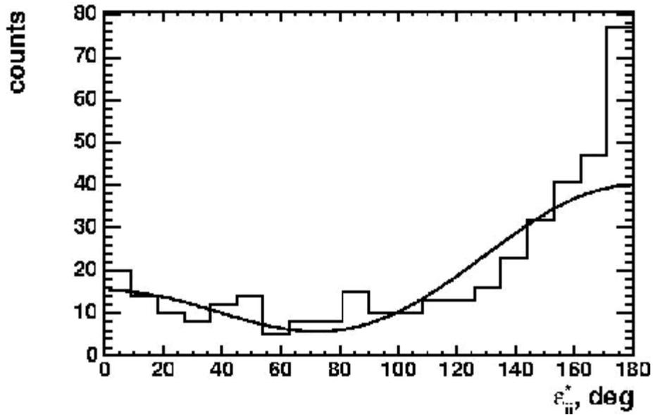
Рис. 4. Распределение по парному азимутальному углу  $\epsilon_{ij}^*$  в системе покоя  $3a$ -частиц для процесса  $^{14}\text{N} \rightarrow 3a + X$ . Кривая – расчет по модели прямого статистического распада  $^{14}\text{N} \rightarrow 3a + X$ .
