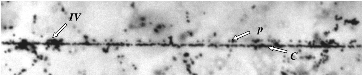
Фото 1. Фрагментация ядра  $^{14}\text{N} \rightarrow \text{C} + \text{H}$  с импульсом 2.86 А ГэВ/с в периферическом взаимодействии на ядре эмульсии. На фото отчетливо видна вершина взаимодействия -IV и узкая струя из двух фрагментов. Один из них, после определения заряда методом счета  $d$ -электронов, идентифицирован как  $Z = 6$  или углерод (C), второй является однозарядным фрагментом. Однозарядный фрагмент идентифицирован по измерениям  $p\beta c$  как протон (p).
