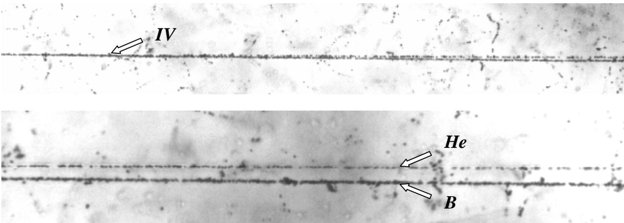
Фото 2. Фрагментация ядра  $^{14}\text{N} \rightarrow \text{B} + \text{He}$  с импульсом 2.86 А ГэВ/с в периферическом взаимодействии на ядре эмульсии. На верхнем фото видна вершина взаимодействия - IV и узкая струя, состоящая из двух фрагментов. При смещении по направлению движения струи фрагментов (нижнее фото) можно различить один фрагмент бора и один двухзарядный фрагмент.
