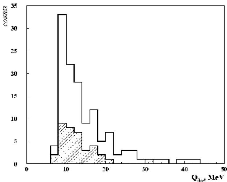
Рис. 6. Распределение по инвариантной энергии возбуждения  $Q_{3\alpha}$  троек  $\alpha$ -частиц относительно основного состояния ядра  $^{12}\text{C}$  для процесса  $^{14}\text{N} \rightarrow 3\alpha + X$ . Незаштрихованная гистограмма соответствует всем двухзарядным фрагментам, с фрагментацией мишени и без (132 события); заштрихованная гистограмма соответствует “белым” звездам (41 событие).
