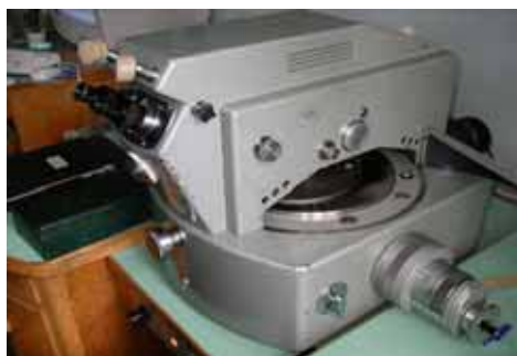
Рис. 20. Внешний вид микроскопа для точных измерений KSM-1 фирмы Zeiss
