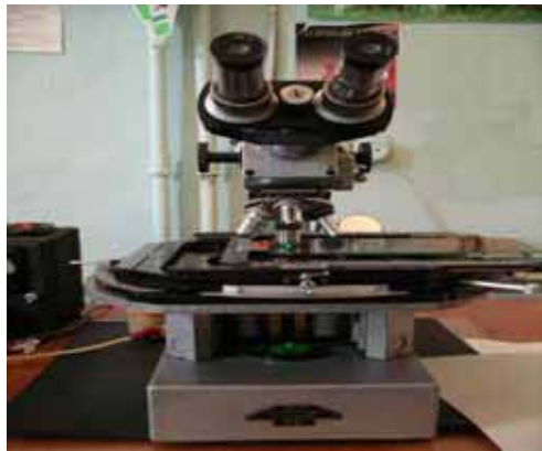
Рис. 27. Внешний вид просмотрового микроскопа МБИ-9.
