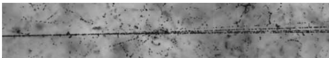
Рис. 5. Фотография события фрагментации ядра {}^{14}\text{N} с энергией 2,1 А ГэВ в периферическом взаимодействии на ядре эмульсии. При смещении по направлению струи фрагментов можно различить 1 фрагмент Н и 3 фрагментов He. Трехмерный образ события реконструирован как плоская проекция с помощью автоматического микроскопа ФИАН комплекса ПАВИКОМ.
