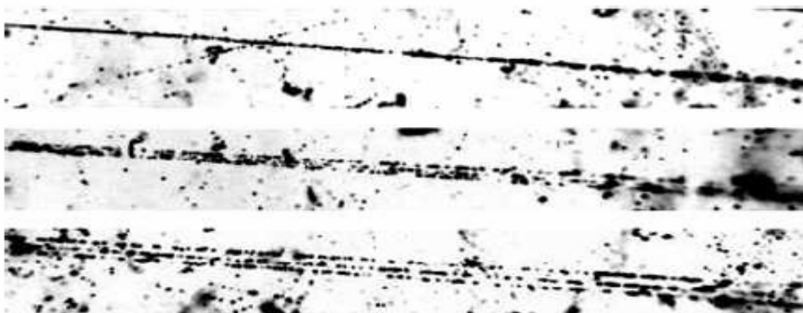
Рис. 8. Фотография события фрагментации ядра ^{12}\text{C} с энергией 4.5 А ГэВ в периферическом взаимодействии на ядре эмульсии на три \alpha частицы. На верхней фотографии видна вершина взаимодействия и струя фрагментов в узком угловом конусе. При смещении по направлению струи фрагментов (нижняя фотография) можно различить 3 фрагмента He.
