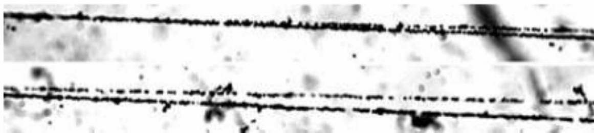
Рис. 10. Фотография несимметричного двойного распада ядра {}^{16}\text{O} с энергией 4.5 А ГэВ в периферическом взаимодействии. На верхней фотографии видна вершина взаимодействия и струя фрагментов в узком угловом конусе. При смещении по направлению струи фрагментов (нижняя фотография) можно различить 1 фрагмент С и 1 фрагмент He.
