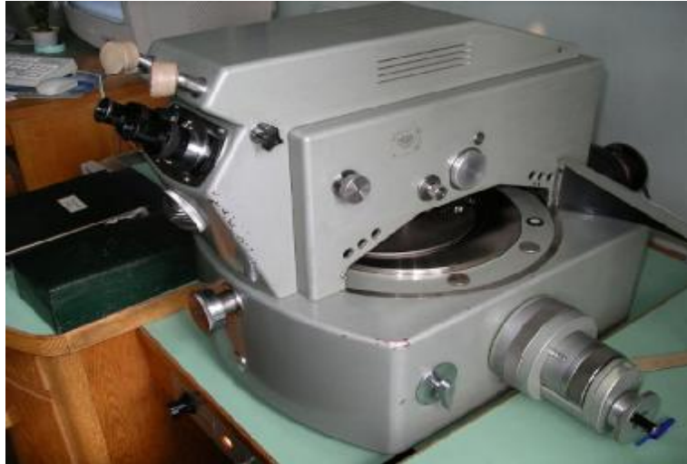
20-расм. Аник улчовчи Zeiss фирмасида ишлаб чикарилган KSM-1 микроскопининг ташки курилиши
