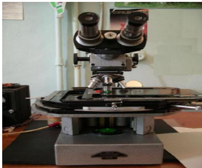
27-расм. Микроскоп МБИ-9 нинг ташки курилиши.
