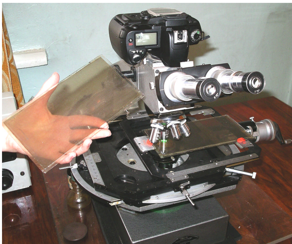
Рис. В.2. Фотография слоя ядерной эмульсии на стеклянной подложке и микроскопа МБИ-9 с установленной фотокамерой НИКОН
