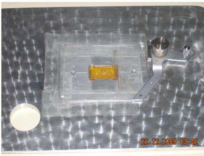
Рисунок 95. Эпоксидная таблетка (жёлтый прямоугольник) с несколькими кристаллами оливина в специальной обойме для крепления на столике микроскопа установки ПАВИКОМ-2.
