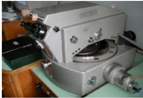
Рис. 20. Външният вид на микроскопа за точни измервания KSM-1 (фирма Zeiss)
