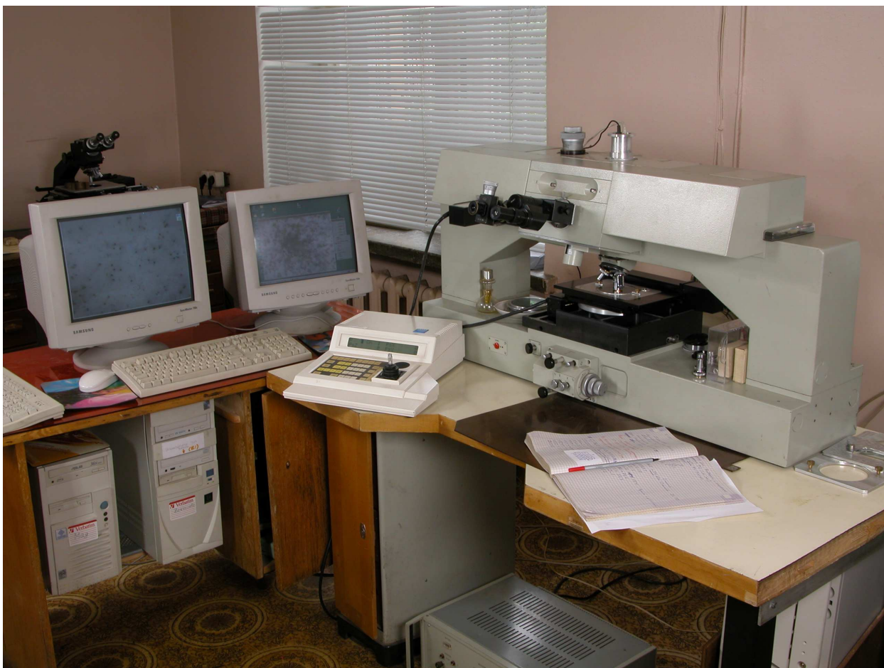
Рис. 4. Установка ПАВИКОМ-2: на микроскопе ЛОМО МПЭ-11 смонтирован просмотрный автоматический стол фирмы Carl Zeiss с управлением через контроллер MCU-26 и CCD-камера с матрицей 768 × 576 пикселей.
