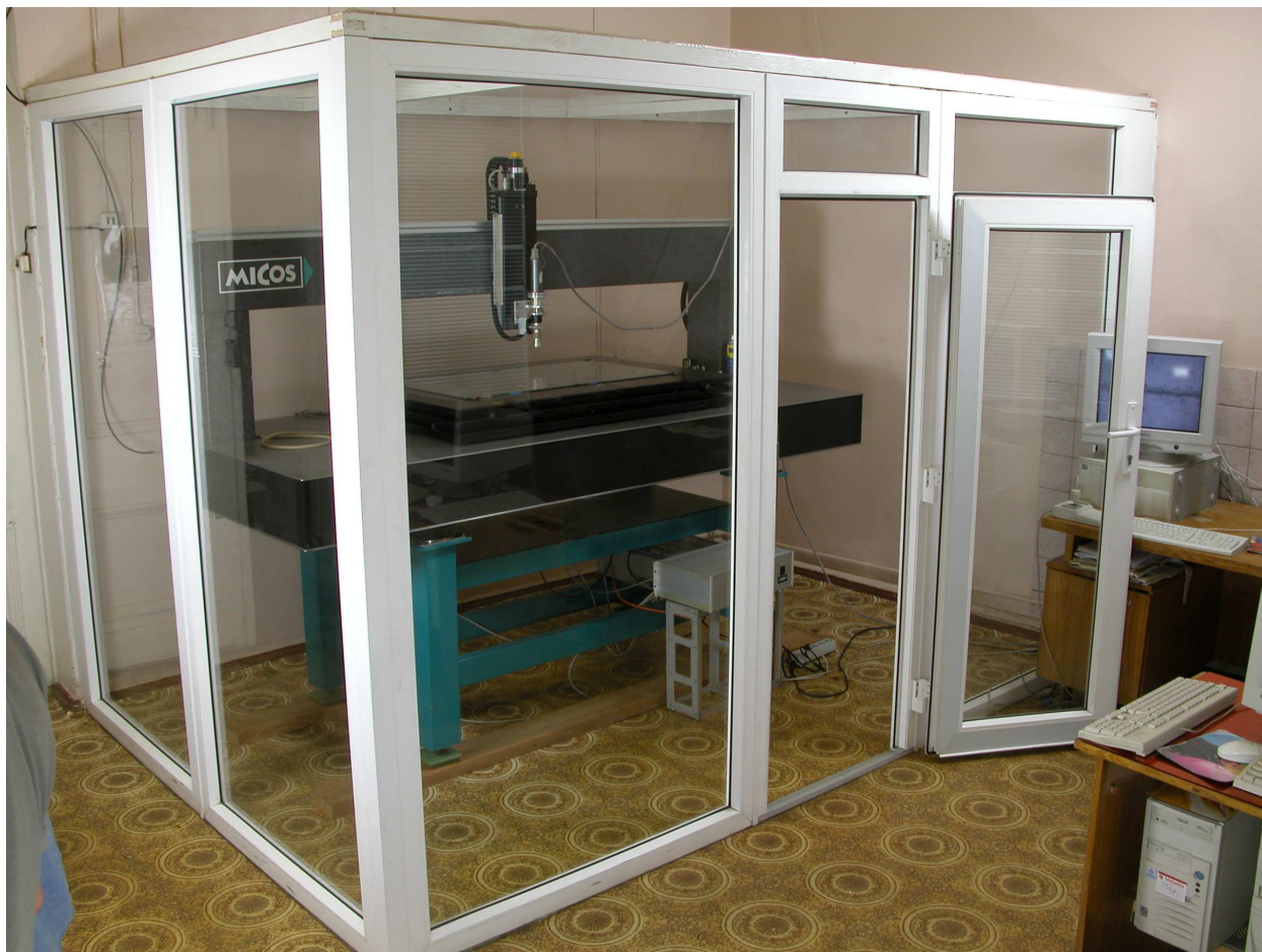
Рис. 3. Установка ПАВИКОМ -1: автоматический прецизионный стол фирмы MICOS с оптической системой, комплектуемой в соответствии с решаемой физической задачей; персональный компьютер осуществляет управление перемещениями стола и подхват видеоизображения, формируемого CCD-матрицей системы VS-СТТ фирмы «Видеоскан».
