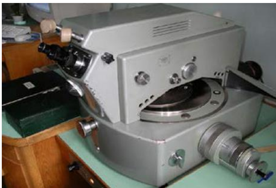
Рисунок 13 – Внешний вид микроскопа для точных измерений KSM-1 фирмы Karl Zeiss.
