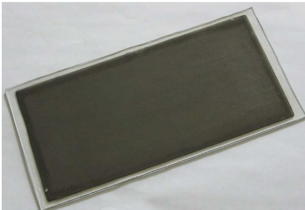
**Рис. В.7.** Фотография эмульсионного слоя. Размеры  $10 \times 20$  см<sup>2</sup>, подложка – стекло
