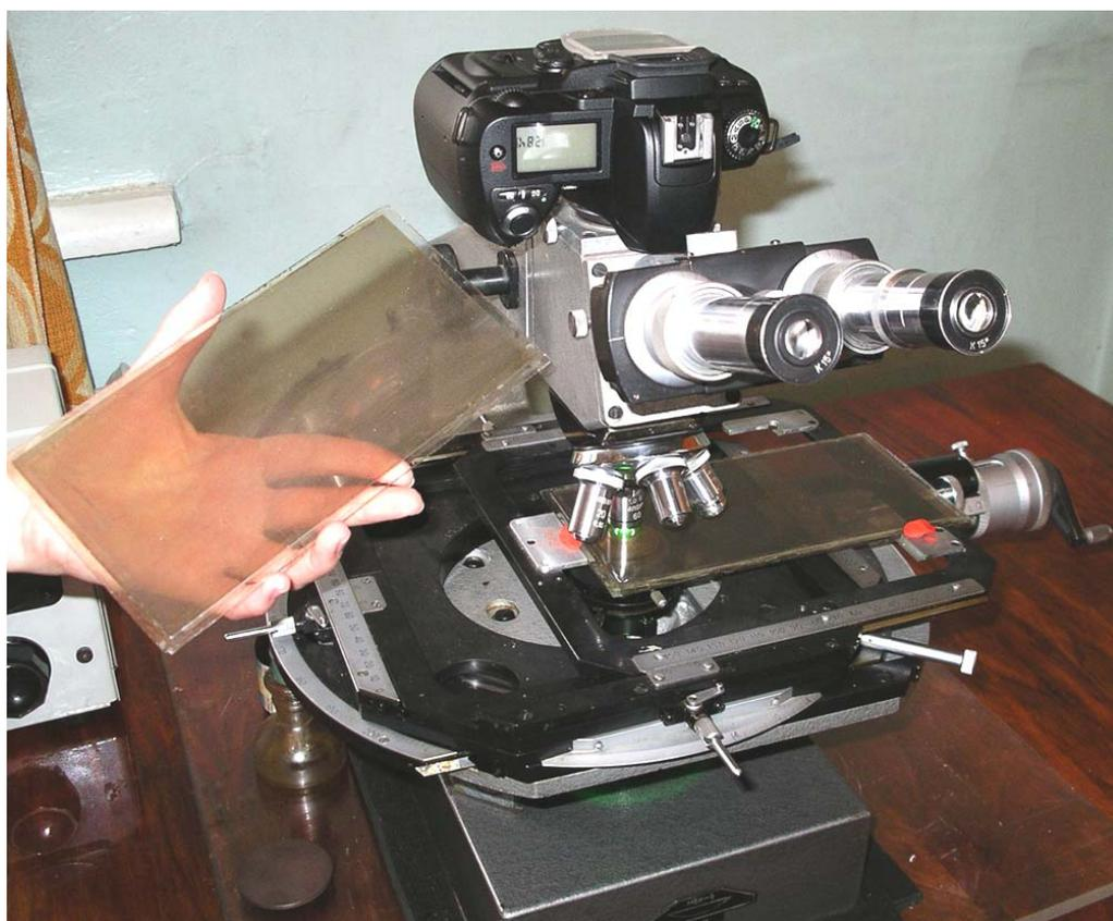
**Рис. В.6.** Фотография слоя ядерной эмульсии на стеклянной подложке и микроскопа МБИ-9 с установленной фотокамерой НИКОН
