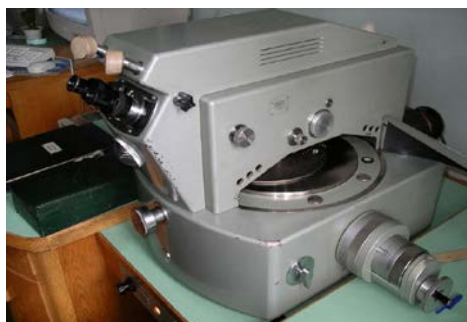
Рис. 10. Внешний вид микроскопа для точных измерений KSM-1 фирмы Zeiss
