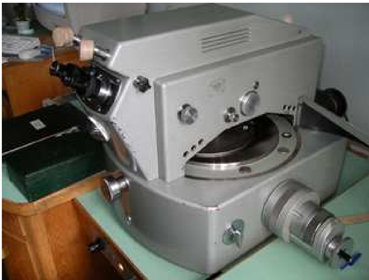
Рис. II.1. Измерительный микроскоп KSM-1.
