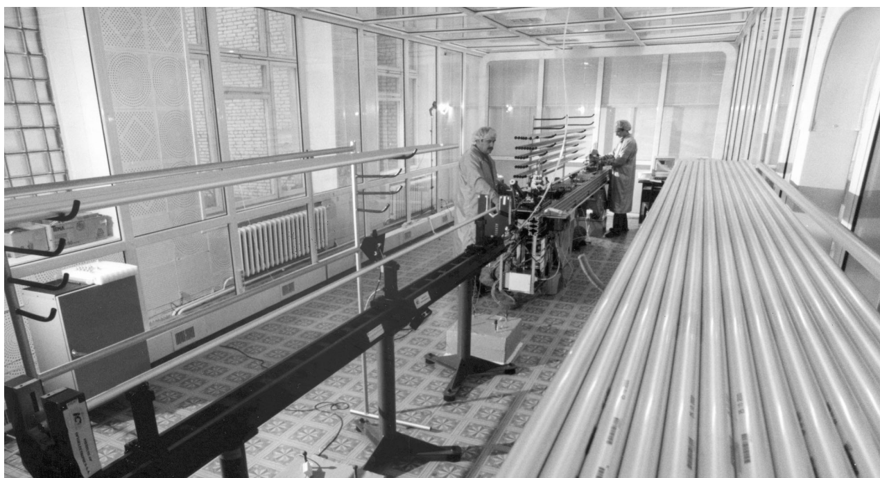
Лаборатория ядерных проблем им. В. П. Джелєпова. Участок по изготовлению дрейфовых трубок для эксперимента ATLAS
