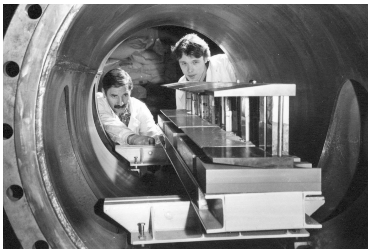
Лаборатория нейтронной физики им. И. М. Франка. Монтаж магнитного канала спектрометра СПН-2
