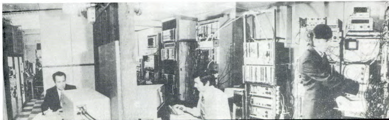
В сеансах на синхрофазотроне в пучках протонов, релятивистских дейтронов и альфа-частиц набрано свыше 1 млн. событий рассеяния на ядрах. Эксперимент ведется в помощьу установки "Альфа", работающей на линии с ЭВМ ЕС-1010.
