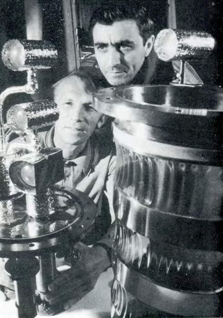
Для ряда экспериментальных установок созданы оригинальные криогенные мишени. На снимке: набор криогенных мишеней /g-H, He, D / для установки "Диск-2".
