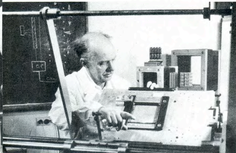
Изготовление каркасов дрейфовых камер и образец готовой камеры. Эти камеры создаются специалистами ОИЯИ для экспериментов по определению радиуса пиона на ускорителе в Батавии.
