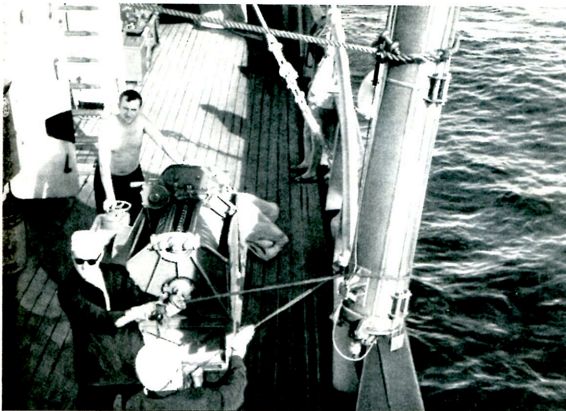
Проба воды, взятая с глубины 500 м с помощью батометра (Тихий океан, район экватора).
