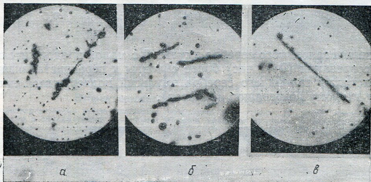
Рис. 3. Микрофотографии эмульсии с различной продолжительностью второго созревания. Увеличение 1500х. а — 1 час второго созревания; б — 3 часа второго созревания; в — 5 часов второго созревания.
