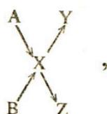
где А — концентрация разбавляемого раствора в %, В — концентрация раствора (в %), используемого для разбавления (если разбавление осуществляется водой, то  $B = 0$ ), Х — требуемая концентрация раствора в %, Y — разница при вычитании В из Х ( $X - B$ ), Z — разница при вычитании Х из А ( $A - X$ ). Для получения  $X\%$ -ного раствора необходимо Y мл разбавляемого раствора А смешать с Z мл раствора для разбавления В.
