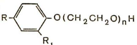
$\text{R}$  — алкильный остаток, содержащий 8—10 атомов углерода  $\text{R}_1=\text{R}$  или  $\text{H}$ ;  $n=10-12$
