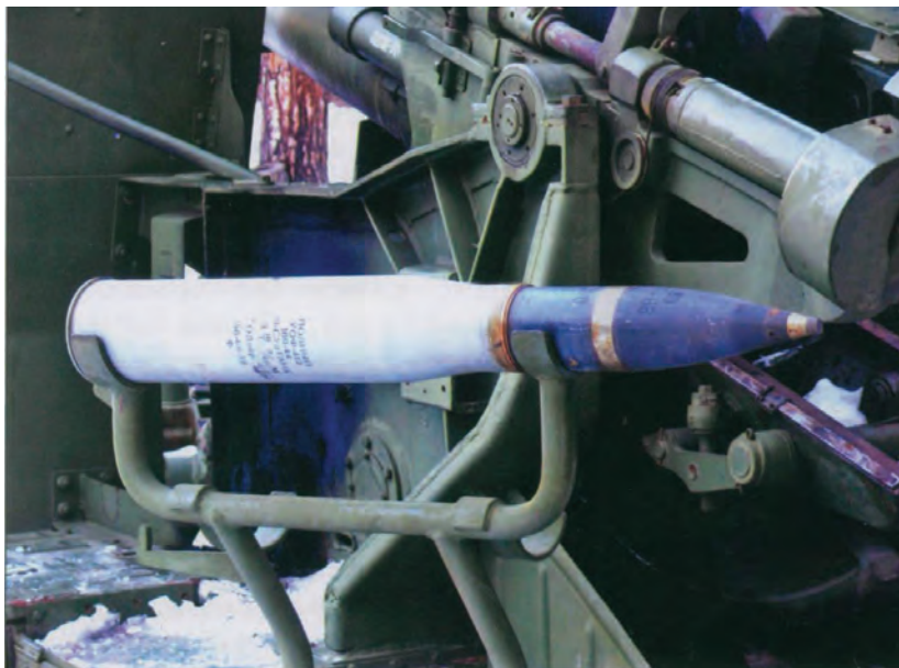
Опыт противолавинных работ в Приэльбрусье показал хорошую эффективность штатных снарядов КС-19 при меньшей их стоимости
