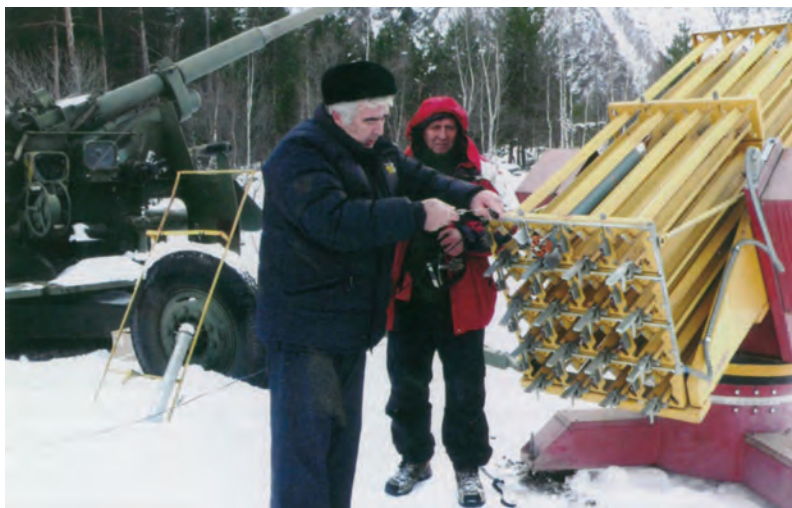
Идет подготовка противолавинной ракеты «Алазань-ПЛ» с пусковой установки «Элия», дальность 4 км, мощность 4,5 кг в тротиловом эквиваленте
