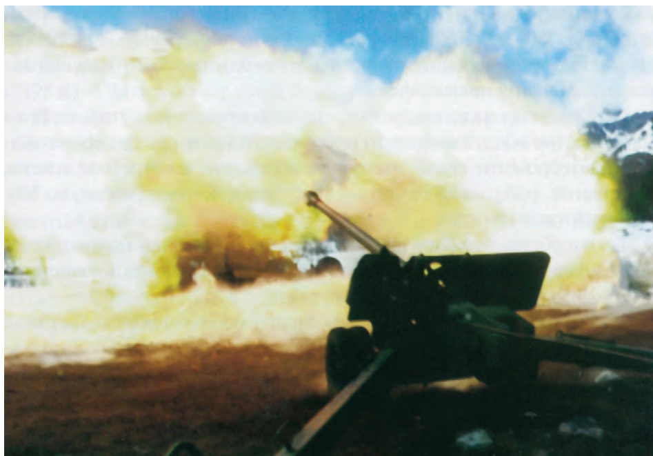
Противолавинные работы с помощью пушек 45-го калибра показали более низкую эффективность по искусственному вызыванию лавин, чем работы с помощью пушек системы КС-19
