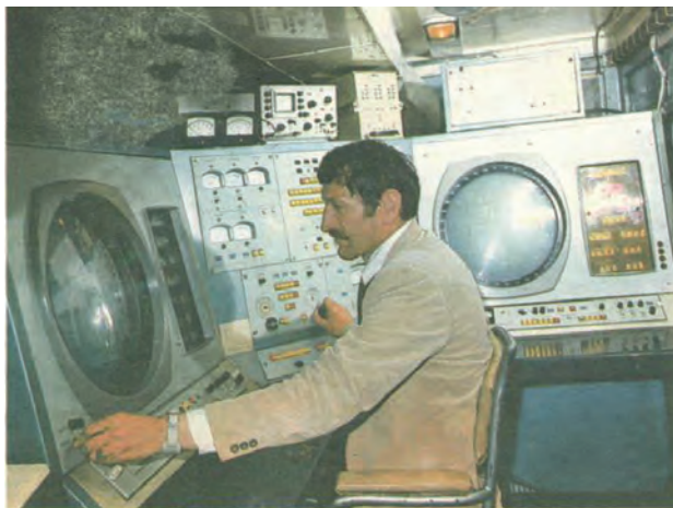
Стационарный радиолокатор для наблюдений за градообразованием.
