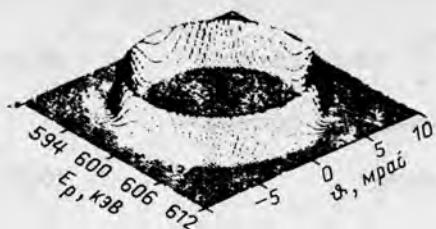
Рис. 6.3. Кулоновский взрыв молекулярного иона \text{HeH}^+ с энергией 3 МэВ при пролете тонкой пленки: кольцевая диаграмма углового и энергетического распределения протонов, рассчитанная без учета поляризации среды
