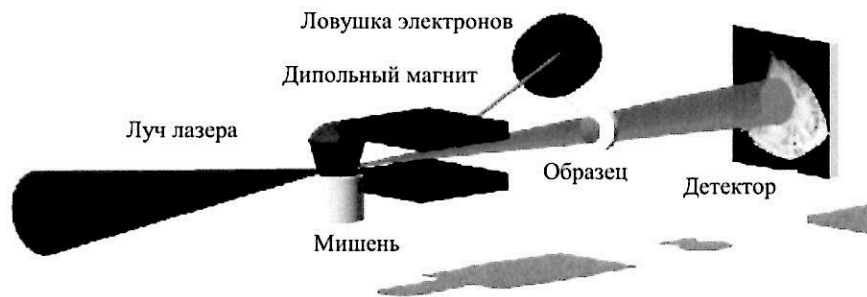
Рисунок 56 – Общая схема лазерно-индуцированных ядерных процессов для получения рефракционного контраста
