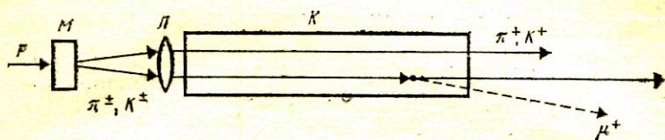
Рис. 2. Схема формирования нейтринного пучка протонного ускорителя: P — пучок первичных протонов; M — мишень; L — фокусирующие линзы; K — распадный канал
