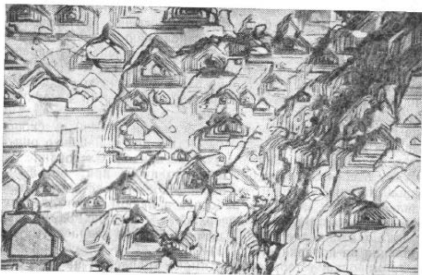
Рис. 8.27. Образование пучков на грани (001) \text{K}_2\text{Cr}_2\text{O}_7 после травления в воде в течение нескольких секунд при комнатной температуре; заметно террасирование ямок травления.
