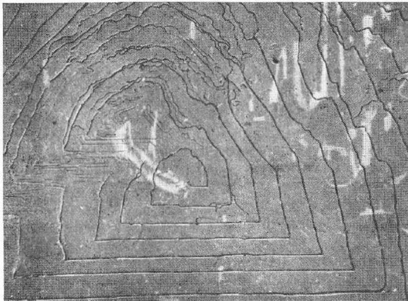
Рис. 2.1. Спирали роста на поверхности (001) бихромата калия [798].
