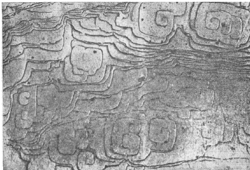
Рис. 2.3. Микрофотоснимок двойных спиралей, наблюдаемых на грани (100) LiF после \gamma -облучения и травления в течение 10 с в водном растворе с содержанием ионов \text{Fe}^{3+} , равным 9 \cdot 10^{-6} [401].
