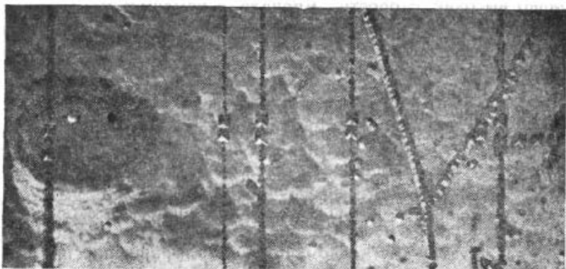
Рис. 11.1. Рост полос скольжения на дислокационных полупетлях на грани (100) кристалла LiF. Поверхность с крупными ямками травления на дислокационных полупетлях была изогнута и потравлена. Как можно видеть, полосы скольжения проходят через пять полупетель [290].
