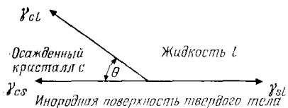
Рис. 3.4. Поверхностная энергия на границах между тремя фазами (две твердые, одна жидкая).
