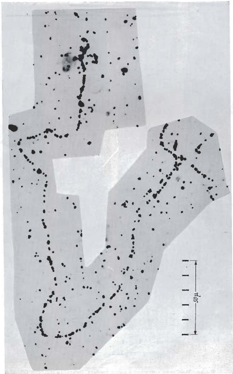
Фото 35. Следы электронов малой энергии в электронно-чувствительной эмульсии Кодак NT4.
