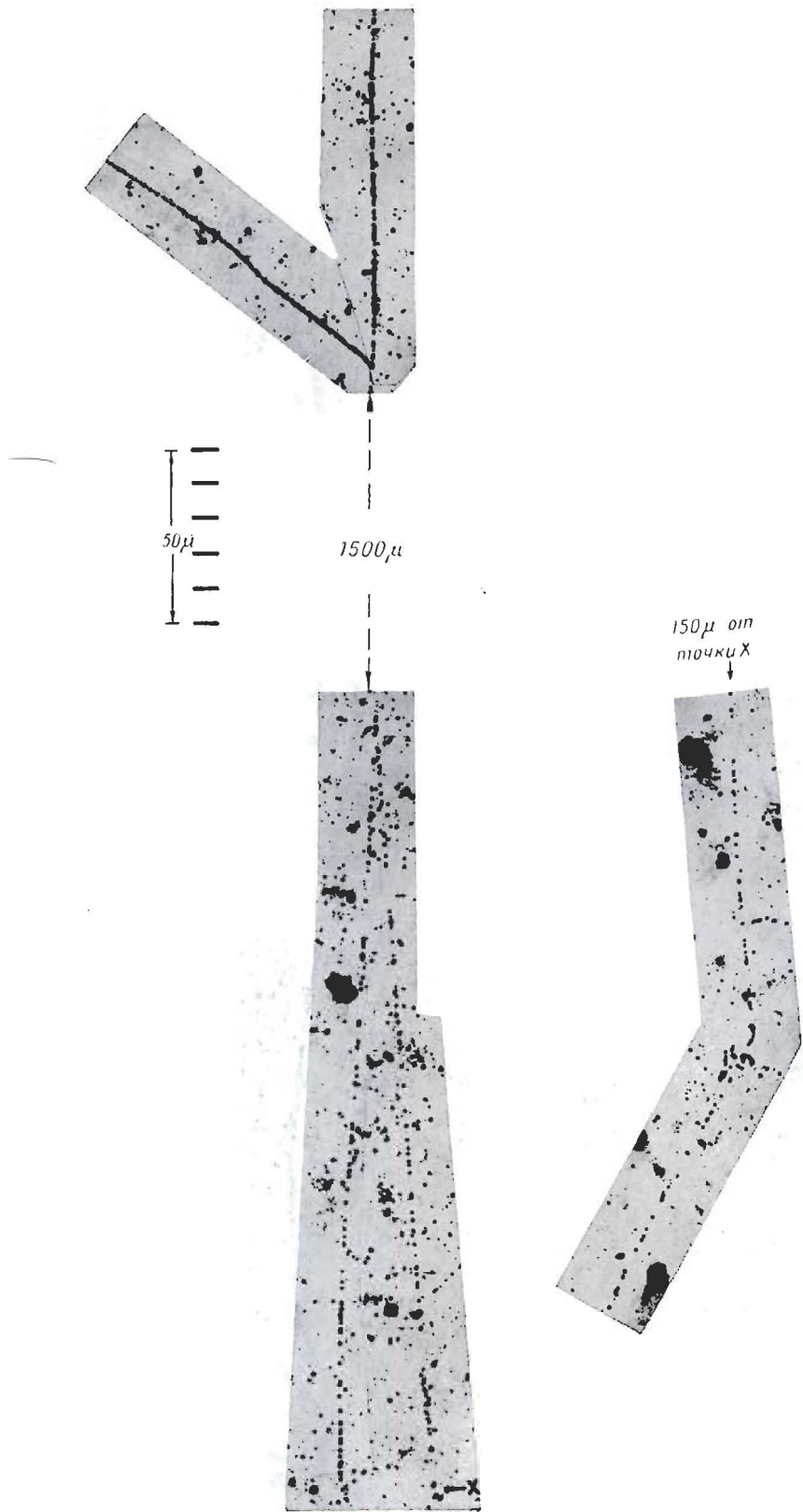
Фото 69. Генетически связанные процессы образования пары заряженных частиц и распада \pi -мезона. Эмульсия Илфорд G5.
