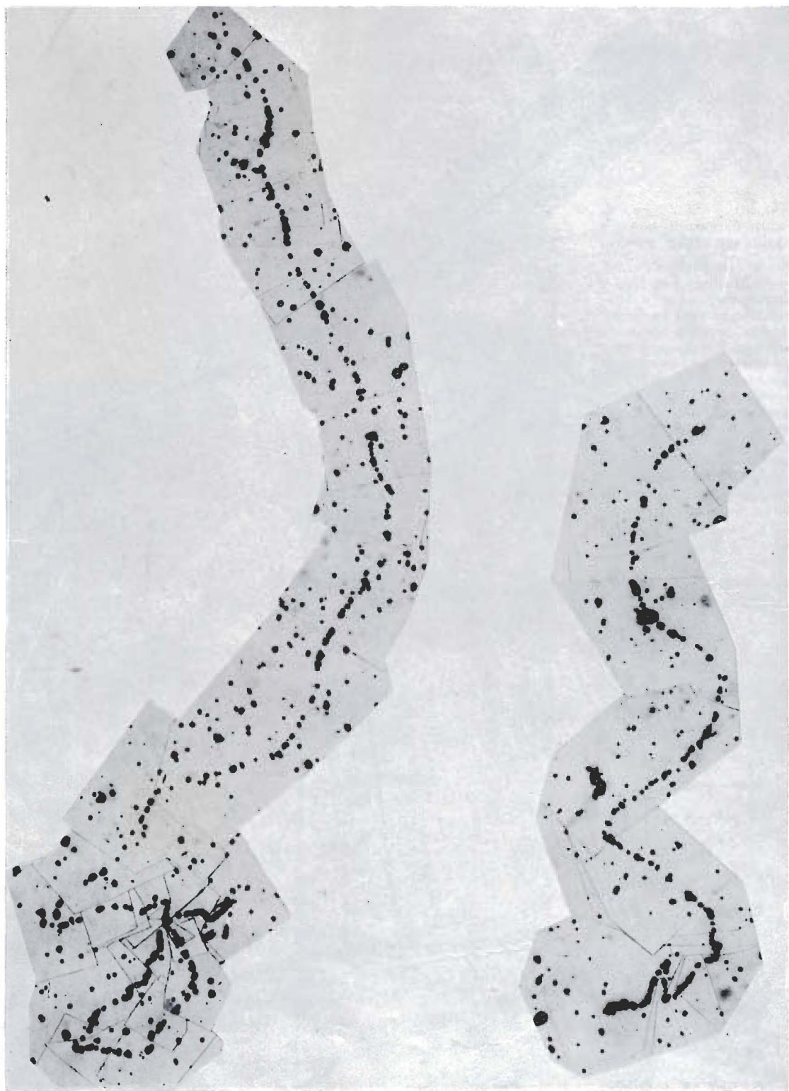
Фото 34. Следы электронов малой энергии в электронно-чувствительной эмульсии Кодак NT4. Частицы испытывают сильное рассеяние вследствие их малой массы. Вблизи самого конца пробега ионизирующая способность повышается и частицы дают в этой области следы с большой плотностью зерен. Подобный эффект бывает хорошо заметен на снимках (см. также фото 35).
