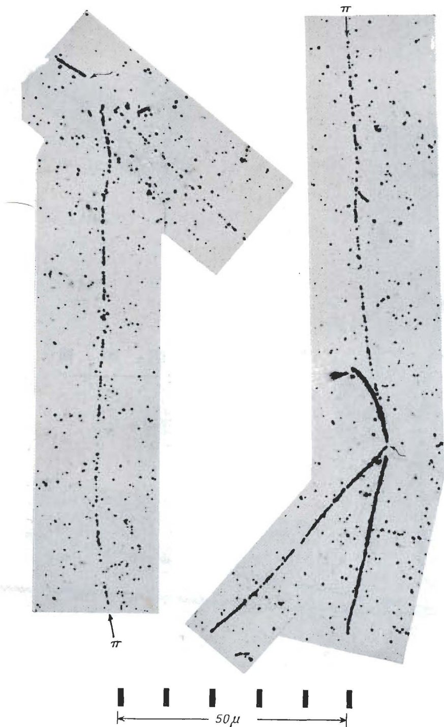
Фото 71. Расщепление ядер легких элементов при захвате \pi^- -мезонов. Эмульсия Иильфорд С2. \pi^- -мезоны достигают конца своего пробега в слое желатины толщиной 5 \mu , помещенной между слоями эмульсии С2. Поскольку расщепление произошло в нечувствительном слое желатины, вершины „звезд“ не зарегистрированы. Эти случаи следует отнести к ядерным захватам мезонов углеродом, кислородом или азотом.
