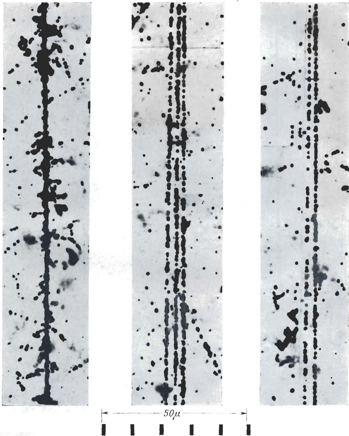
Фото 178. Фрагментация ядер углерода при столкновении. Эмульсия Ильфорт G5.
