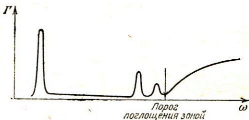
Рис. 10. Схематическое изображение структуры полосы поглощения света кристаллов. Водородоподобные линии поглощения слева от пороговой частоты свидетельствуют о возникновении экситонов
