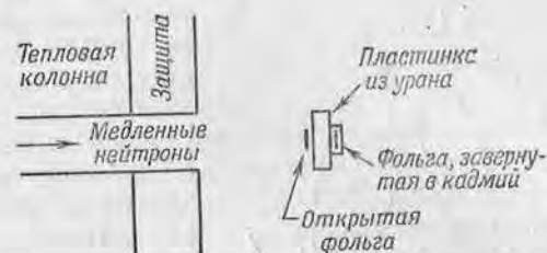
Фиг. 43. Принцип получения нейтронов деления без примеси резонансных нейтронов при помощи преобразователя из урановой пластинки.
