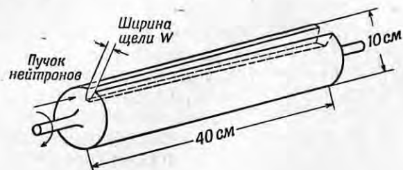
Фиг. 72. Ротор механического селектора Аргоннской лаборатории [25].
