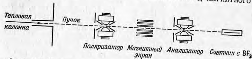
Фиг. 154. Установка для измерения деполаризации нейтронов в различных образцах методом «двойного пропускания» [46].
