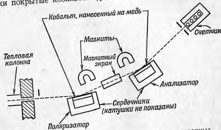
Фиг. 152. Установка для получения поляризованных нейтронов путем отражения от зеркал [12].
