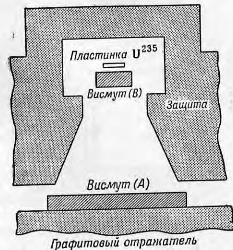
Фиг. 91. Расположение висмутовой защиты в канале для активации образцов нейтронами деления брукхаузенского котла.
