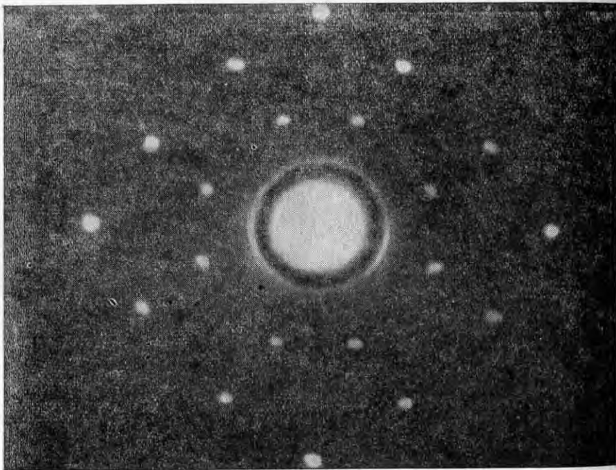
Фиг. 115. Лауэграмма кристалла NaCl, полученная Шуллом и Волланом [17] на котле в Ок-Ридже.
