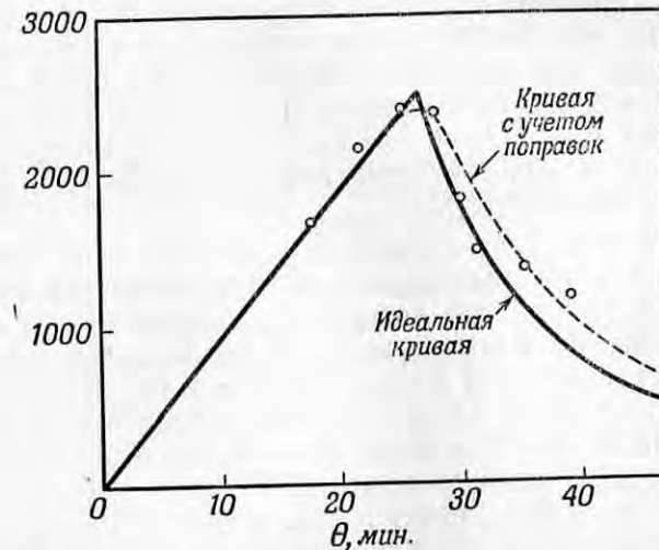
Фиг. 134. Определение критического угла при отражении от зеркала из бериллия. Кривые рассчитаны из эффективного сечения для связанных атомов бериллия (приложение III).
