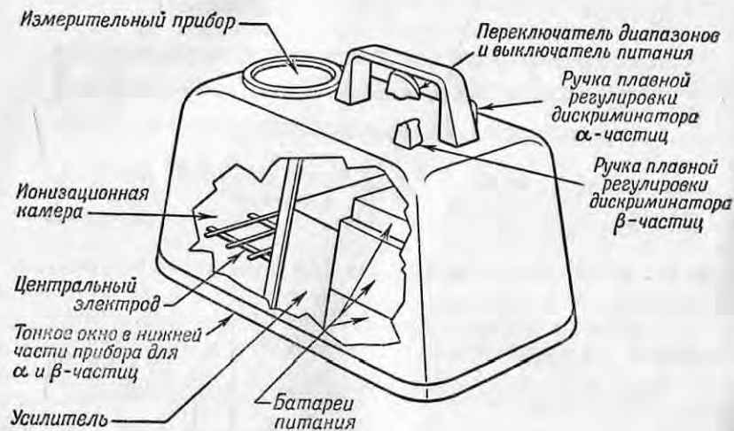
Фиг. 159. Переносный дозиметр для различных видов излучения с ионизационной камерой и собственным источником питания.
