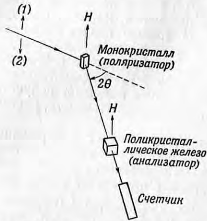
Фиг. 153. Установка для получения поляризованных нейтронов путем отражения от магнетита [40]. Поляризация измеряется по пропусканию поликристаллического железа.
