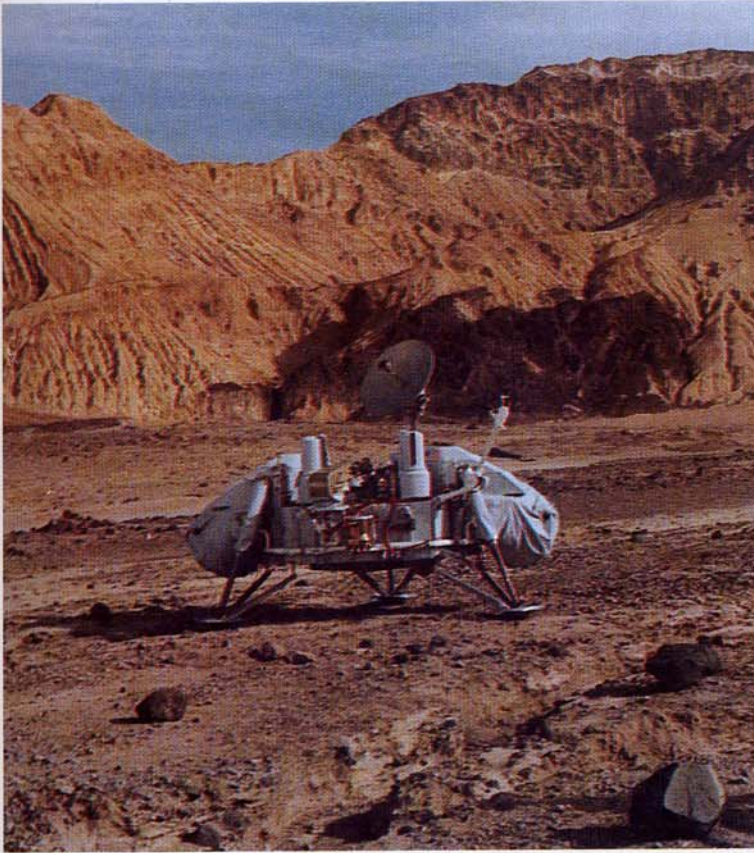
Спускаемый аппарат «Викинг» на испытаниях в Долине Смерти, Калифорния. Между двумя турелями с телевизионными камерами располагается магазин с еще неразвернутой рукой-манипулятором. Фото Б. Рэя
