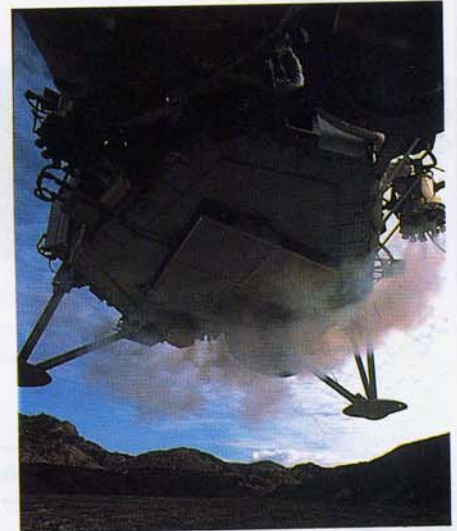
Моделирование посадки «Викинга» на Марс в Долине Смерти, Калифорния. На последней стадии спуска включаются тормозные ракетные двигатели. Фото Б. Рэя
