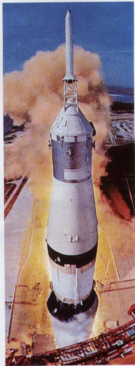
Многоступенчатая ракета на жидком топливе — прямой потомок первых экспериментов Годдарда. Корабль «Аполлон-11» под командованием Нила Армстронга 16 июля 1969 г. отправляется с мыса Канаверал во Флориде в свой трехдневный полет к Луне. С разрешения NASA
