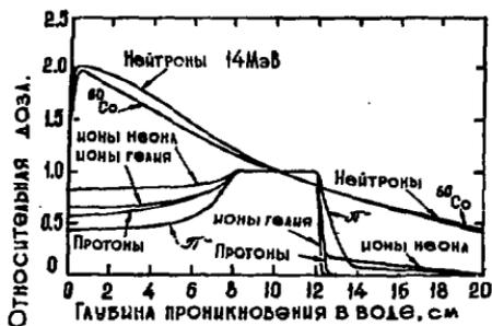
Рис.2. Глубинные дозные распределения пучков тяжелых заряженных частиц, гамма-лучей  $\text{Co}-60$  и пучка нейтронов с энергией 14 МэВ /5/.
