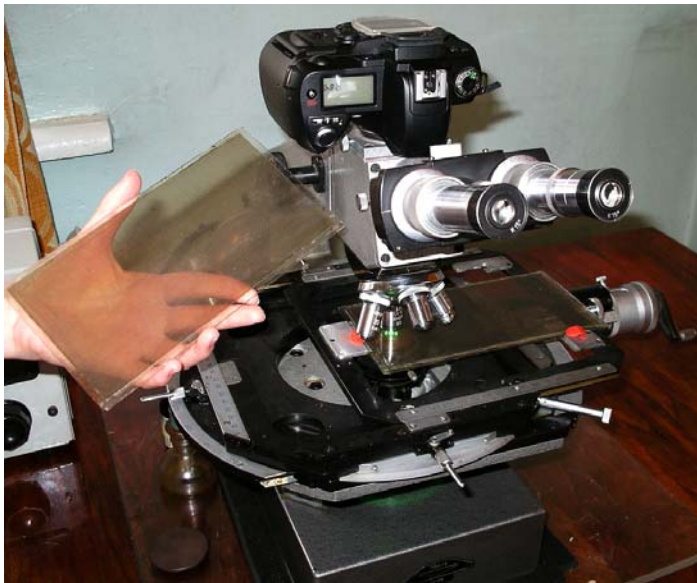
Рис. 3. Фотография слоя ядерной эмульсии на стеклянной подложке и микроскопа с установленной фотокамерой.
