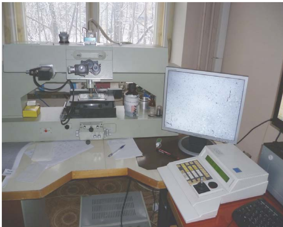
Рис. 15. Автоматизированный комплекс ФИАН на основе микроскопа МПЭ-11 с управляемым столиком, видеокамерой и платой захвата изображения; на экране – изображение облученной пленки.
