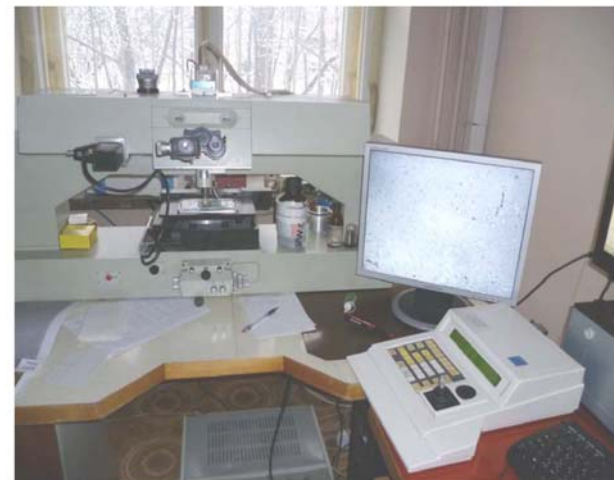
Рис. 8. Автоматизированный комплекс ПАВИКОМ-2 (ФИАН; создан на основе микроскопа МПЭ-11 с управляемым столиком, видеокамерой и платой захвата изображения); на экране – изображение участка облученной эмульсионной пленки
