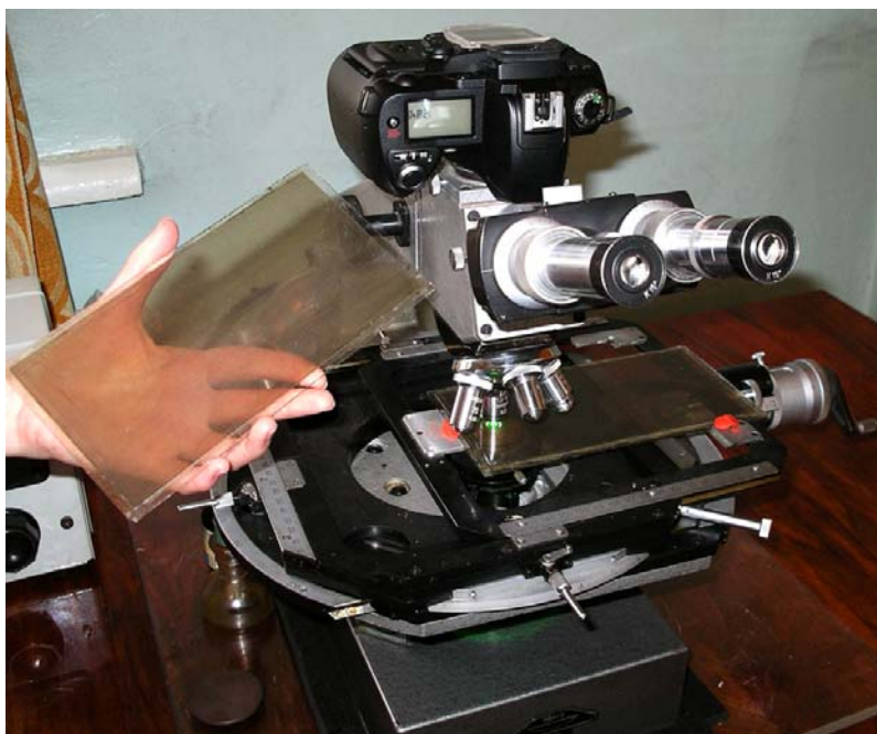
Рис. В.3. Фотография слоя ядерной эмульсии на стеклянной подложке и микроскопа МБИ-9 с установленной фотокамерой НИКОН
