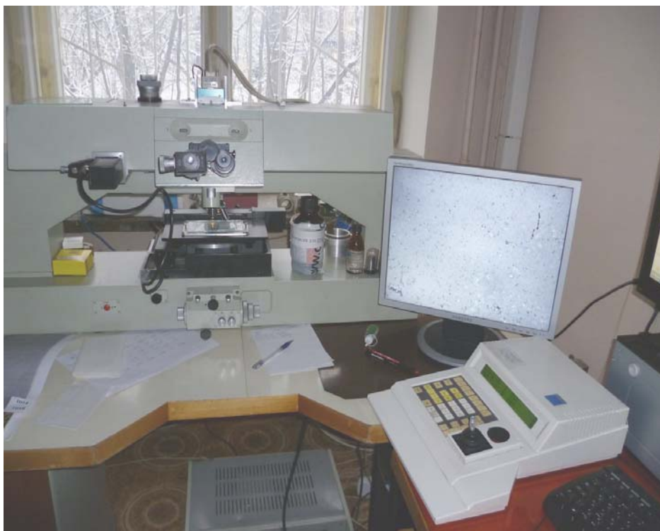
Рис. IV.19. Автоматизированный комплекс ФИАН на основе микроскопа МПЭ-11 с управляемым столиком, видеокамерой и платой захвата изображения; на экране – изображение облученной пленки
