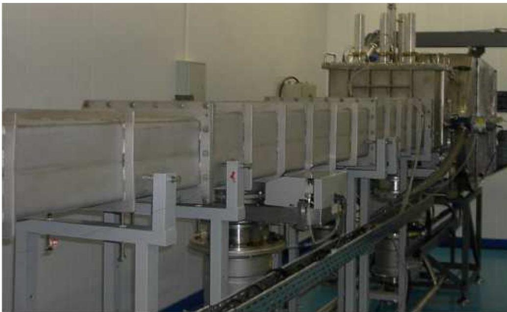
Рис. 32. Канал для транспортировки пучка к установке для облучения полимерных пленок.
