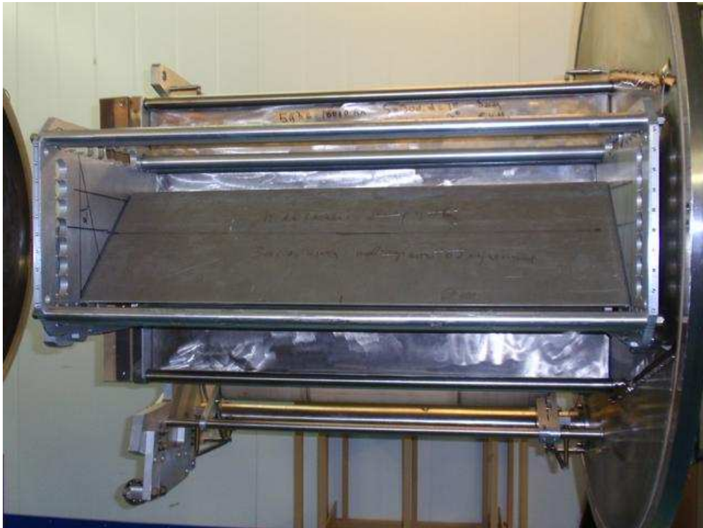
Выдвижная часть камеры с доской для крепления образцов, выставленной под углом 45^\circ
