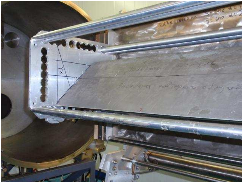
Положение доски под углом 45^\circ к пучку ионов
